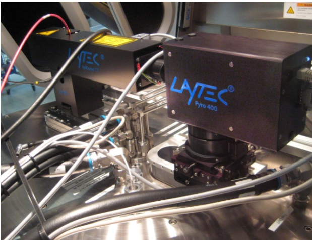
Fig. 1: 기판의 휨과 온도 및 반사율을 동시에 측정하기 위해 Aixtron G4 Planetary® system에 장착한 Pyro 400 과 Epi-Curve®TT
